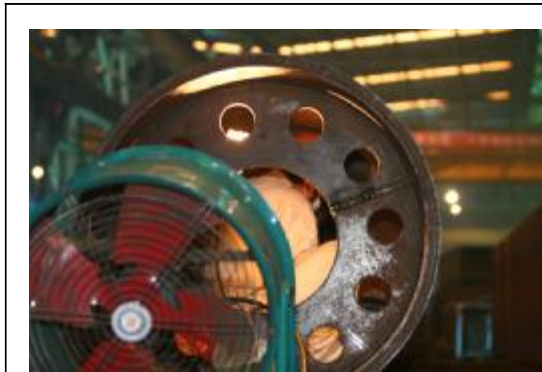
工厂员工正在箱体中进行焊接高温作业
